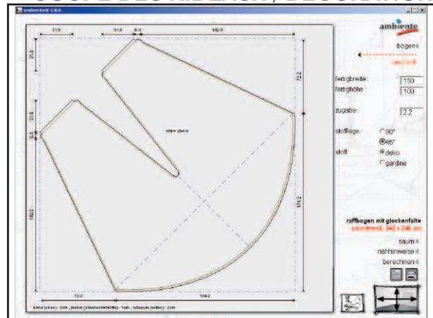
Réalisation des modèles de coupe à l'échelle pour une multitude de formes de rideaux avec une vérification logique et des conseils de couture
